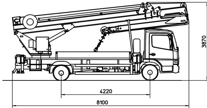
Der Böcker Autokran AK 32/1500 SPS wird auf einem LKW 7,49 t, z.B. DB 815/4x2/4220 aufgebaut.
